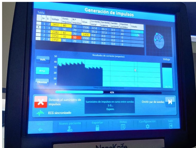
Figura 2. Dispositivo NanoKnife®, Angiodynamics, Latham, NY, USA. Se muestra la planificación y evolución de la intervención. Parámetros expresados en la tabla: S+ y S-: electrodos o agujas que muestran la dirección de la corriente, del polo positivo al negativo; voltaje de la corriente (voltios); duración de los impulsos (microsegundos); número de impulsos; voltaje por
